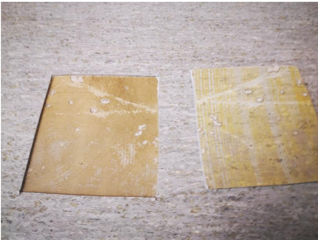
Kuva 20. Luokkahuoneen 55 lattian muovimaton kiinnitys alustaan oli hyvä ja liima oli hyvässä kunnossa. Liima tuoksui heikosti kemikaalimaiselle ja näytteenoton yhteydessä pintatasoitetta irtosi hieman pohjastaan.
