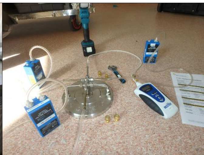
FLEC3. Kuvassa FLEC-kammio on asennettu tutkittavalle lattiapinnalle, josta kerätään materiaaliemissionäyte Tenax -adsorptioputkiin.
