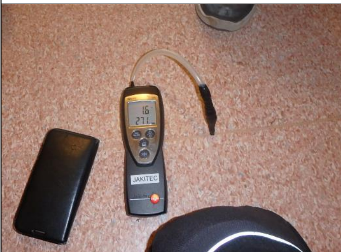
Merkkiainekokeen MA17* aikana mitattiin paine-ero 2. kerroksen ja välipohjan eristetilan välillä. Eristetila oli alipaineinen 2. kerroksen käytävään nähden, jossa oli ylipaine 1,5...2 Pa.
