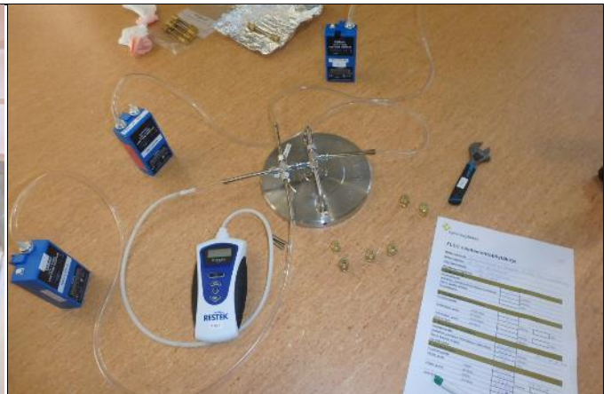
FLEC4. Kuvassa FLEC-kammio on asennettu tutkittavalle lattiapinnalle, josta kerätään materiaaliemissionäyte Tenax -adsorptioputkiin.
