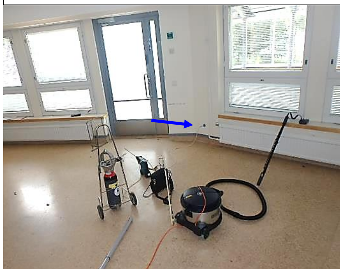
Merkkiainekoe MA2 suoritettiin B-osan pohjakerroksen aulan ulkoseinään. Sijainti on esitetty paikannuspiirustuksessa 2.
