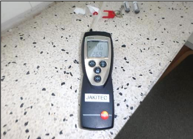
Alipaine tilassa merkkiainekokeiden MA14 ja MA15 aikana oli 3,5...5 pascalia ulkovaipan yli.
