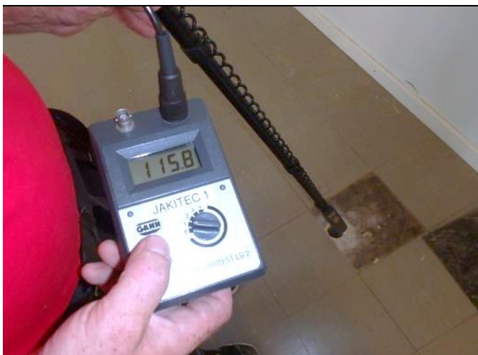
R21. Vinyylilaatan alta tarkasteltiin pintakosteutta, se oli myös koholla, yli 115.
