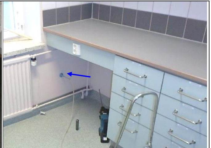
Merkkiainekoe MA15 suoritettiin saman huoneen ulkoseinään.
