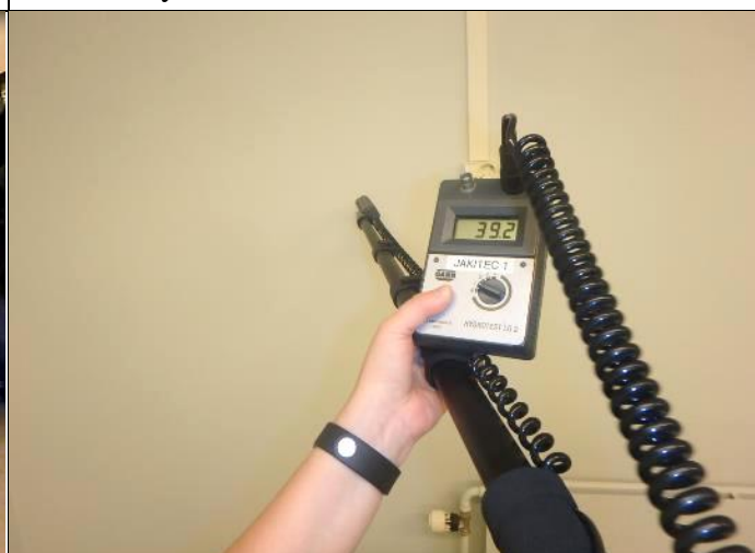
Saman seinän pinnasta toiselta puolelta (C-osan varasto) myös tarkasteltiin pintakosteuslaitteella. Ei poikkeavaa.
