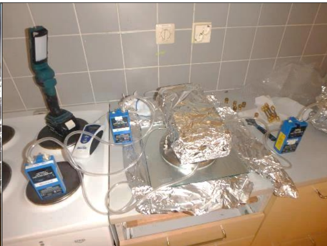
Huuhtelun jälkeen kammioon liitettiin kaksi näytteenottopumppua ja kerättiin nollanäyte Tenax -adsorptioputkiin.
