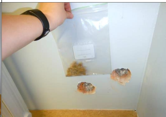
Ulkoseinän lämmöneristevillasta otettiin mikrobinäyte MIR25.
