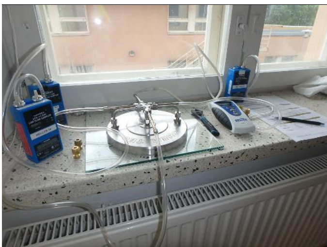
FLEC3. Kuvassa FLEC-kammio on asennettu emissiovapaalle alustalle (lasilevy), ennen nollanäytteen ottoa laitteisto huuhdeltiin 45 min.
