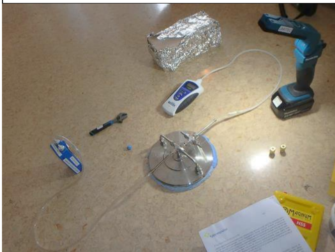
Näytteenottoaika (aulan lattiapinnoite) pyyhittiin kuivalla nukkaamattomalla liinalla ja siirrettiin siihen FLEC-laitteisto. FLEC-kammio tiivistettiin tiivistemassalla lattiapintaan. Tiiviyttä tarkistettiin mittaamalla tuuletusaukosta tulevaa virtausnopeutta. Puhdistusputki vaihdettiin ja pintaa tuuletettiin 45 min ajan näytteenottoaukot suljetuina.
