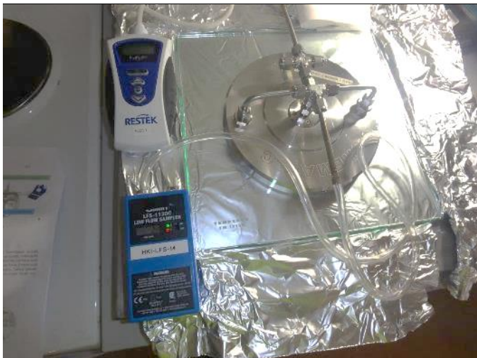
FLEC1. Kuvassa FLEC-kammio on asennettu emissiovapaalle alustalle (lasilevy), ennen nollanäytteen ottoa laitteisto huuhdeltiin 45 min.
