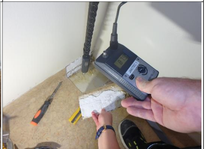
Tutkimushetkellä pintakosteuslukema oli hieman koholla (87).
