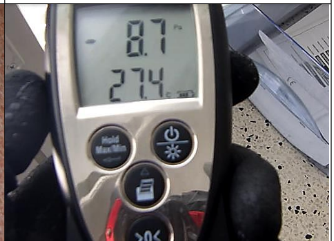
Lisäksi mitattiin paine-ero C-osan 1. ja 2. kerrosten välillä. 1. kerroksen tila oli reilusti alipaineinen 2. kerroksen tiloihin nähden.
