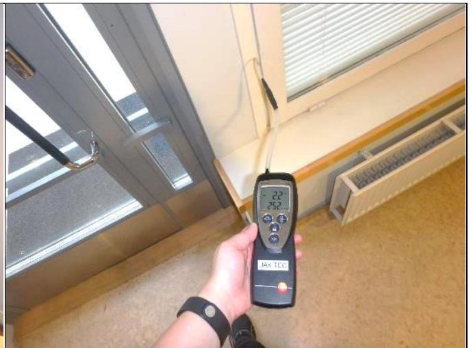
Merkkiainekokeen aikana tilassa mitattiin painero ulkovaipan yli ikkunan kautta. Alipaine oli noin 2...2,5 pascalia ulkoilmaan nähden.
