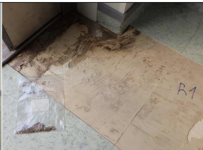
Muovimaton liimasta ja tasoitteesta otettiin mikrobinäyte MIR1.
