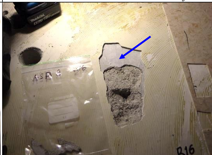
Alapohjan vanhasta tasoitteesta (alempi) otettiin asbestinäyte ASB8. \Rightarrow Tasoitte ei sisällä asbestia.
