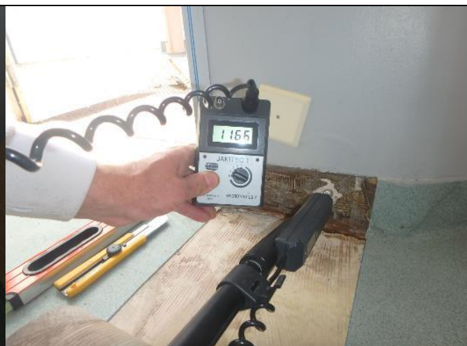
Seinän alaosa myös tarkasteltiin pintakosteutta, tämä oli myös koholla, 116.
