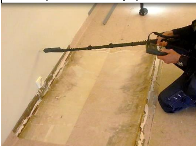
Pintakosteus oli koholla myös seinän alaosassa anurin osoittamasta kohdasta alaspäin (70...120), kuiva vertailuarvo seinässä ylempänä on 40.
