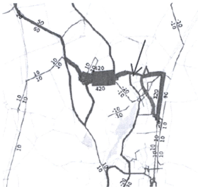
Kuva 6.7. Raskaan liikenteen määrän kasvu arkivuorokausina on esitetty punaisella värillä, kun uusi jatke länteen Vähänummentieltä kantatie 45 toteutetaan. Hankkeen sijoittuminen on esitetty punaisella nuolella.
