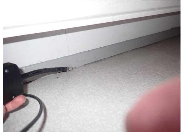
Kuva 13: Merkkiainevuotoa Joukahaisten nukkumatilán lattia-seinäliitoksesta.
