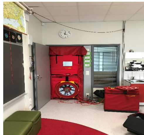
Tutkittava tila alipaineistettiin automaattisella alipaineistuskalustolla.
