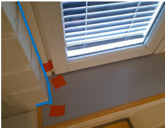
Kuva 9. Normaali ja alipaineistettuna ikkunaliittymässä vähäistä ilmapuotoa.
