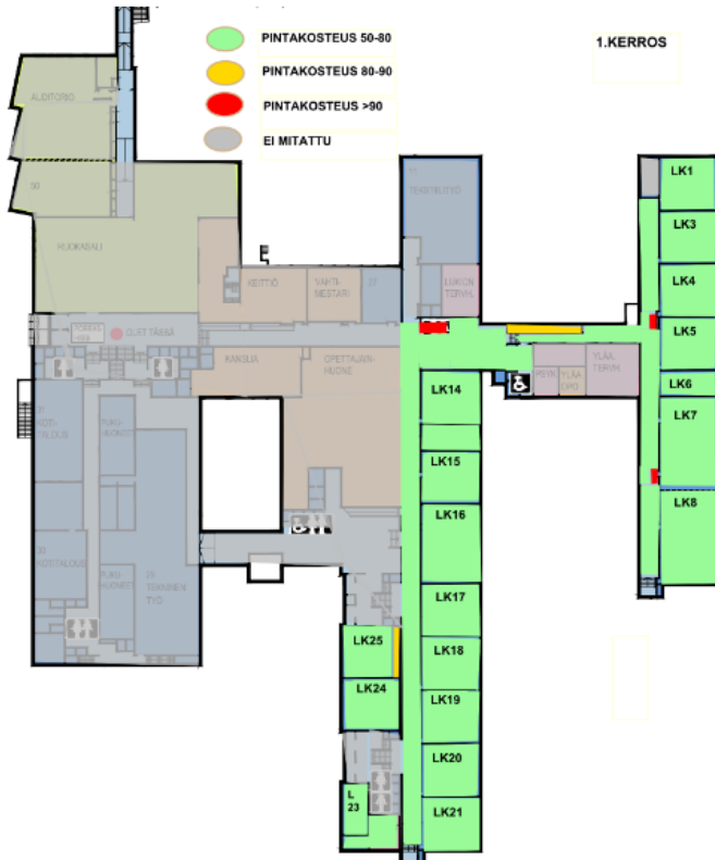
Kuva 15. Ensimmäisen kerroksen pintakosteuskartoitus.
