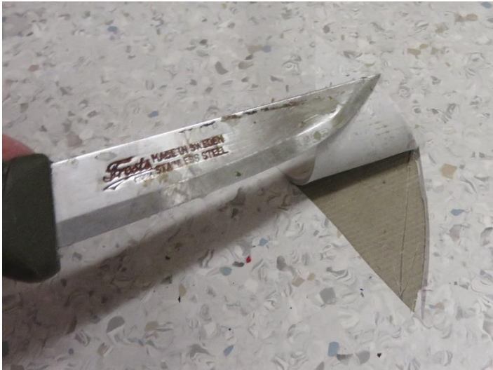
Kuva 2. Liiman kunto luokassa 51 oli hyvä eikä hajua havaittu. Matto oli kevyesti alustaansa kiinnittynyt.
