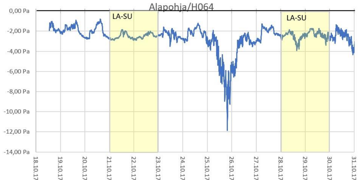
Kuva 9. Paine-eromittaukset huoneesta 064 alapohjaan nähden 18.10. – 31.10.2017.
