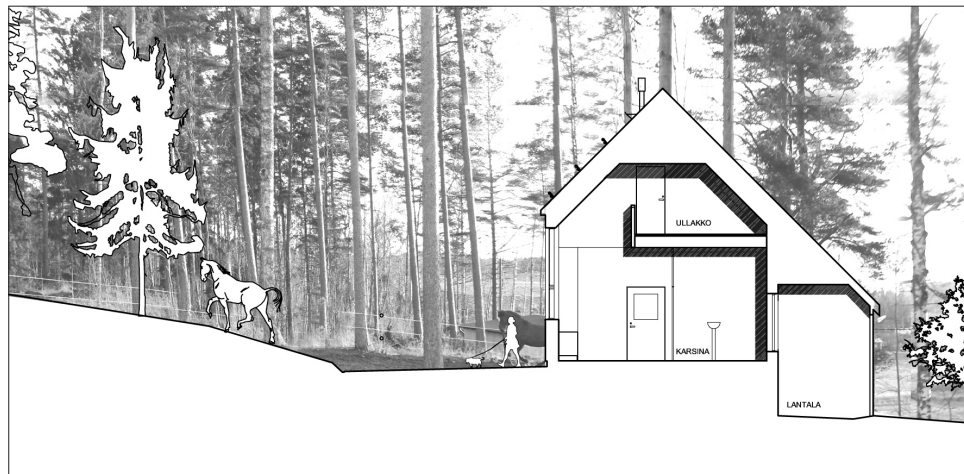
Kuva 17. Korkeuseroja hyödyntävä lantala. Talli Kekkapää, Espoo. © Pook Arkkitehtitoimisto
