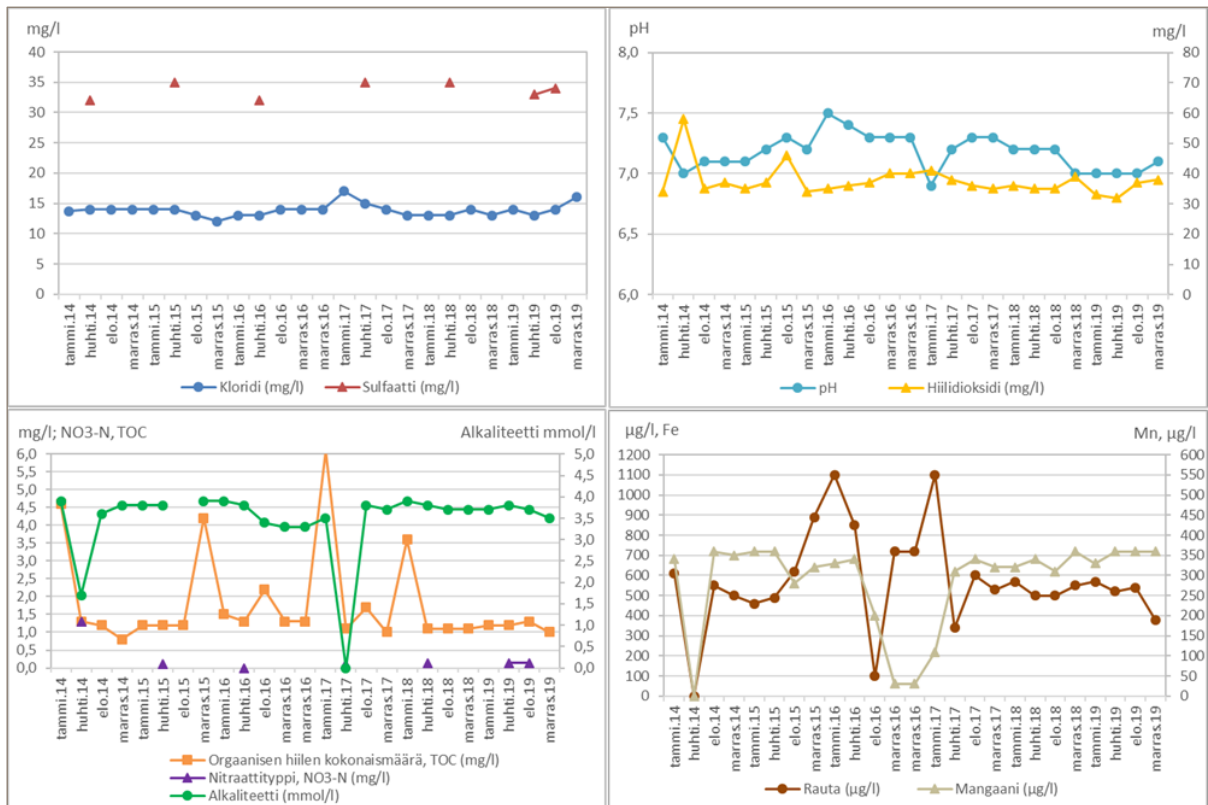
Kuva 25. Pohjaveden laatu Korkeamäen vedenottoaikavossa (raakavesi) vuosina 2014 – 2019.
