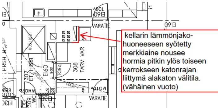
Kuva 20 Toisen kerroksen tarvikevaraston tutkimuskartta
