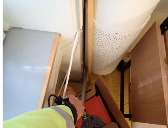
Kuva 30. Normaalissa ja alipaineistettuna pilarin juurella vähäistä ilmavuotoa.
