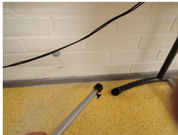
Kuva 22. Alipaineistettuna lattiasa noin 500 mm matkalla vähäistä ilmavuotoa.
