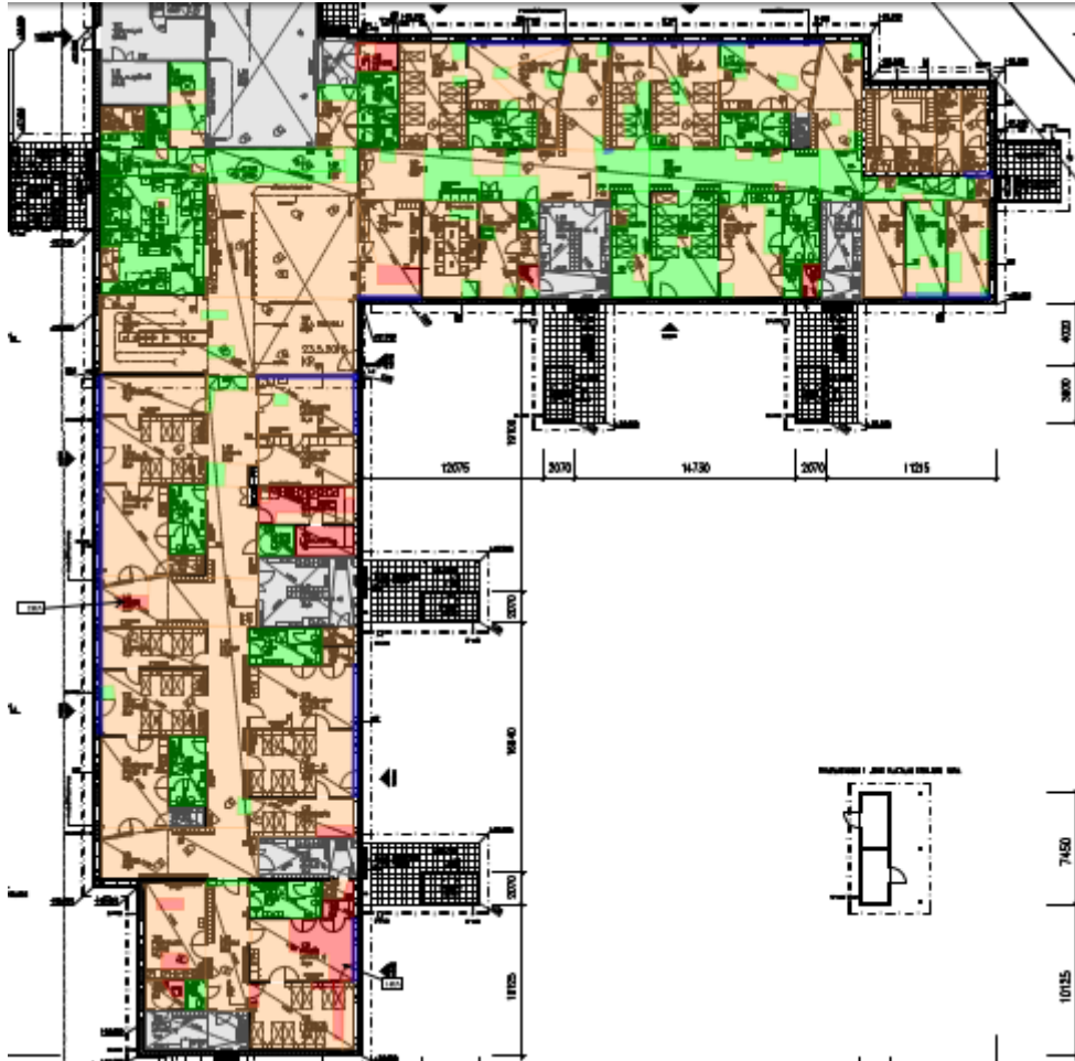
Kuva 6. Pintakosteuskartoitus, koko rakennus.
