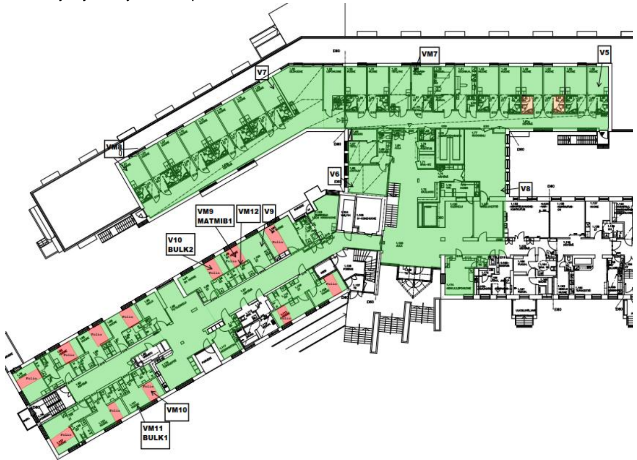
Kuva 7. Pintakosteustasot sekä näytteenottoapaikat 1.kerroksessa.
