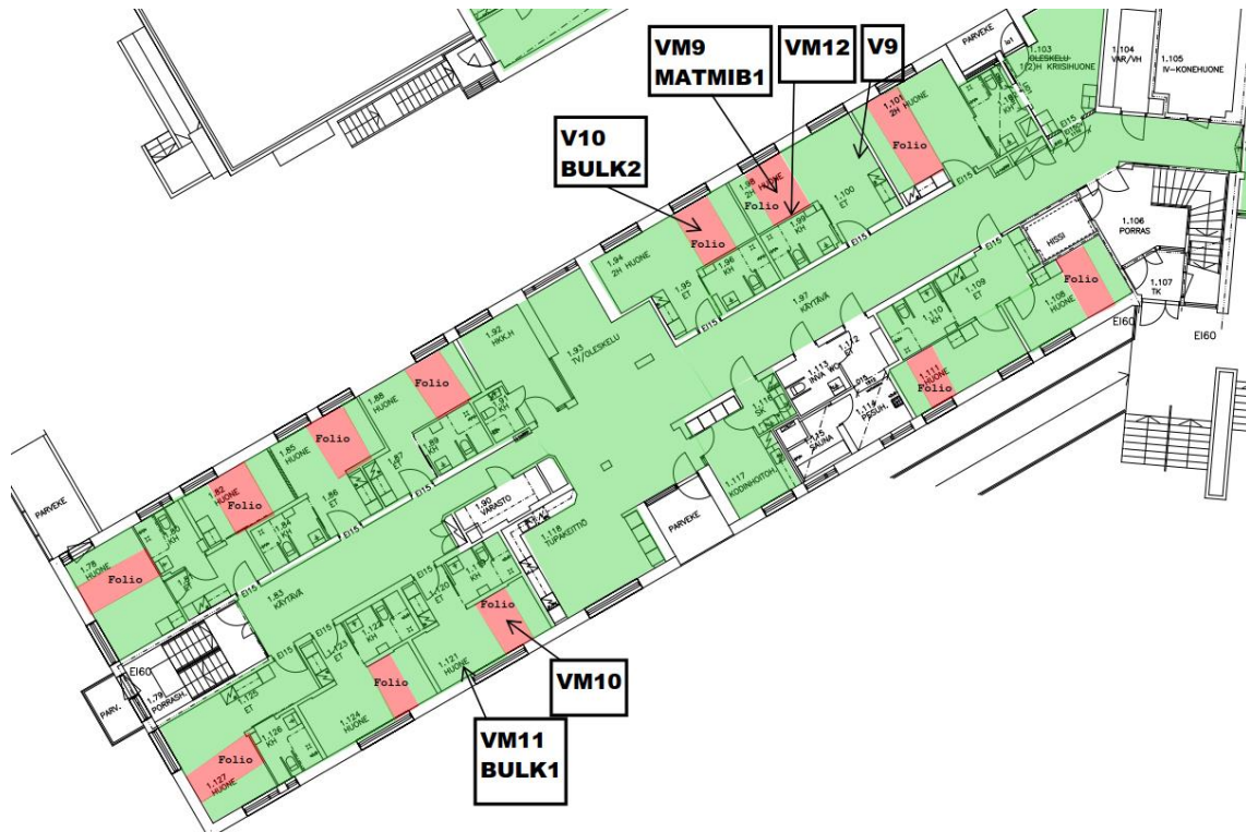
Kuva 10. Pintakosteustasot sekä näytteenottopaikat D - siiven eteläosassa. Huoneissa, joissa pintakosteustasot olivat kohonneet, oli maton alla foliopaperimainen alusta.
