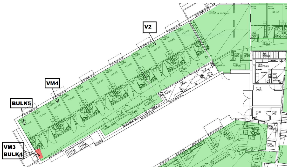
Kuva 4. Pintakosteustasot sekä näyteenottoaikat A-B- siiven eteläosa, pohjakerros. Viilto- mittauskohdassa VM3 kosteuspitoisuus maton alla oli korkea.
