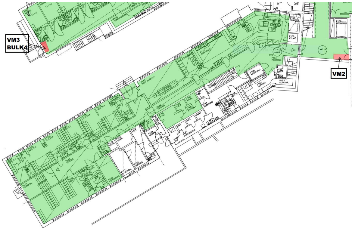
Kuva 5. Pintakosteustasot sekä näytteenottoaikat D - siiven eteläosa, pohjakerros.
