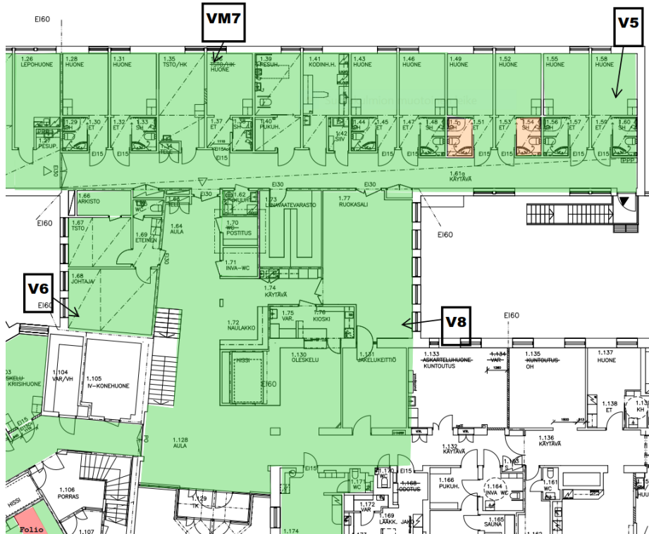
Kuva 8. Pintakosteustasot sekä näytteenottoaikat ensimmäisessä kerroksessa A-B-siiven pohjoisosassa sekä ruokasalissa ja aulassa.
