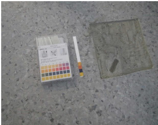
Kuva 3 Tasoitteen pH mittaus
