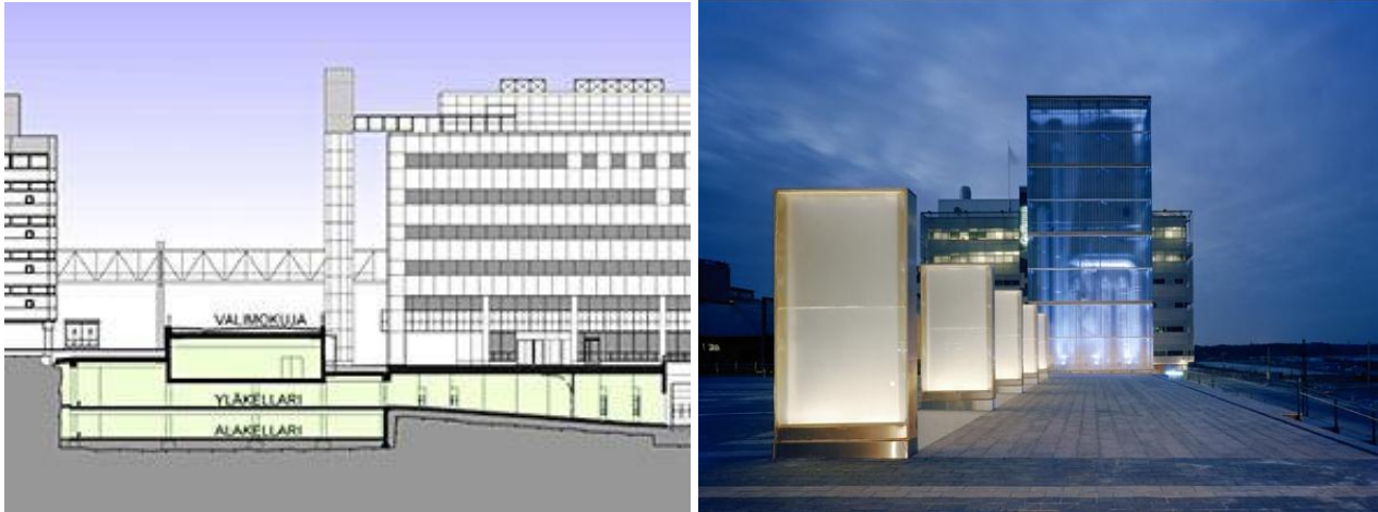
Kuva 7. Vasemmalla periaatekuva pysäköintikellarin ja kansipysäköinnin yhdistämisestä. (Lähde: Fira) Oikealla maanalaisen pysäköintihallin päälle rakennettu aukio. (Lähde: Arkkitehtuuritoimisto B&M)
