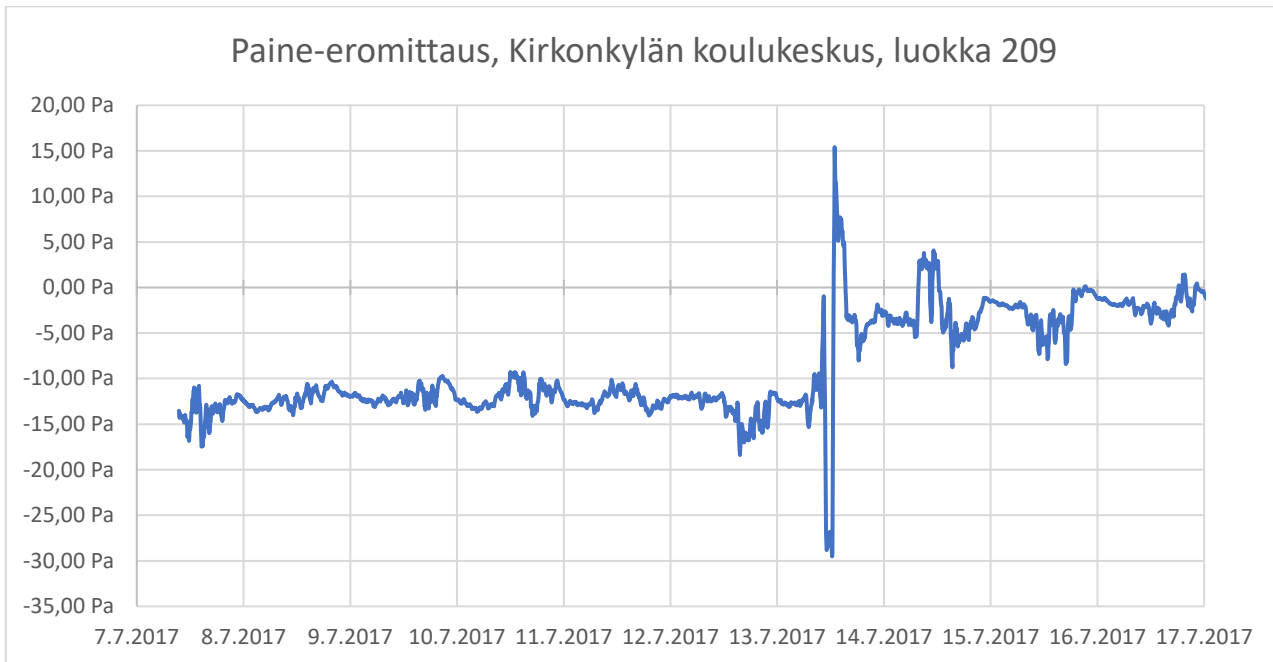
Kuva 7. Luokan 209 paine-eromittaukset suhteessa ulkoilmaan 7.7.2017 – 17.7.2017.
