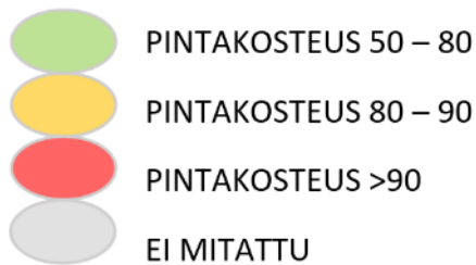
Kuva 151. Pintakosteuskartoituksessa käytettyjen värien suhteelliset kosteustasot.
