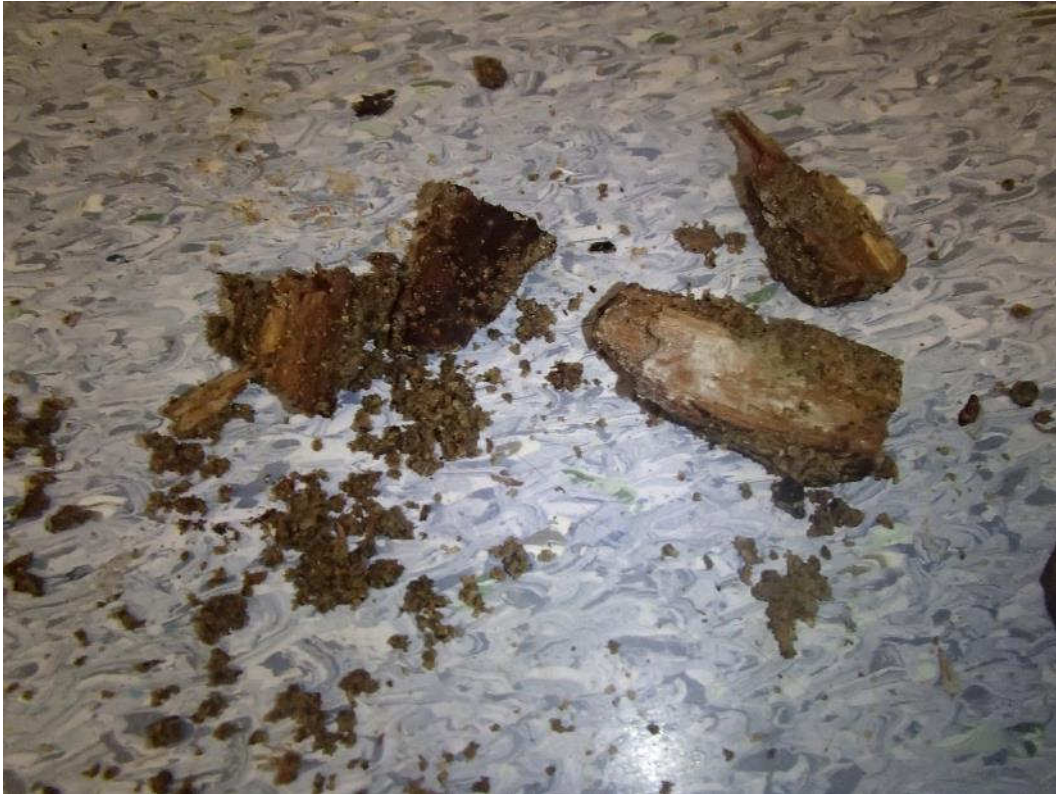
Kuva 134. Maanvastaiset muottilaudat ovat lahonneet.
