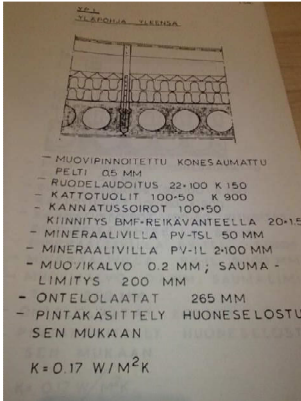
Kuva 39. Alkuperäisten suunnitelmien mukaiset yläpohjan rakenteet.
